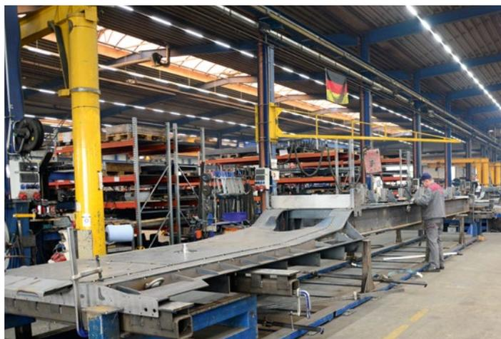
In der neuen KTL- und Pulveranlage werden u.a. Sattelaufleger und Anhänger für Lkws vorbehandelt und beschichtet; hier der auf dem Kopf liegende Rohbau eines Aufliegers.
